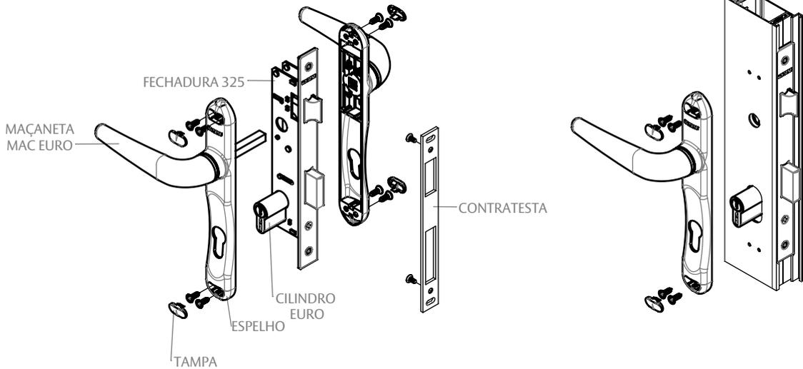
2. PASSO: ENCAIXAR A HASTE PELO OUTRO LADO DO PERFIL ATÉ ENCOSTAR NO FUNDO DA MAÇANETA INSTALADA NO LADO OPOSTO
